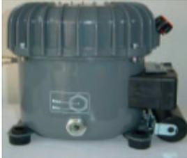
L'aggregato silenzioso che consente la produzione di aria compressa fino a 8 bar è un compressore a pistone lubrificato a spruzzo.
