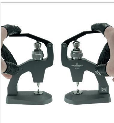
Deux index permettent l'emploi de la potence aussi bien par la **gauche** que par la **droite**.
