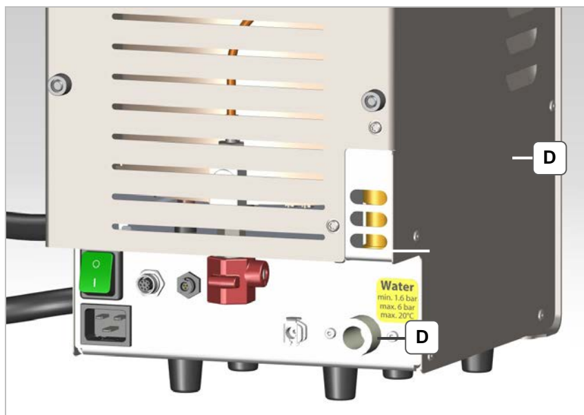
Imagen 4.4.2: Conexión del aparato (D) al suministro de agua (tubería de agua)
