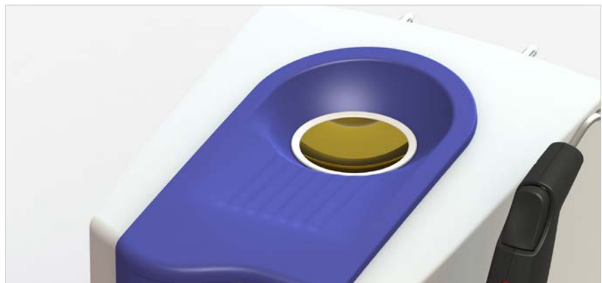
Fig. 5.2.2. Tamiz introducido en la cuba colectora para el llenado
