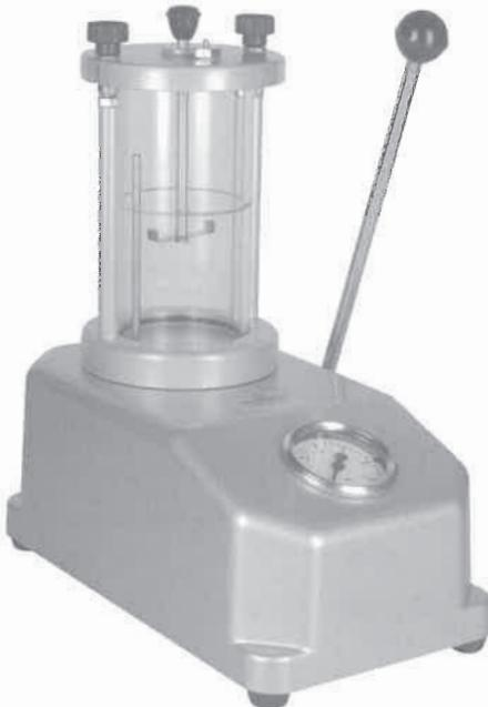
**Appareil à contrôler l'étanchéité des boîtes de montres**
