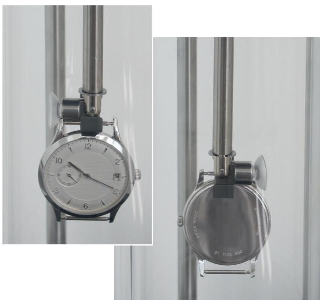
Immerger la montre et immédiatement retirer l'air du cylindre en tournant le bouton "B".
