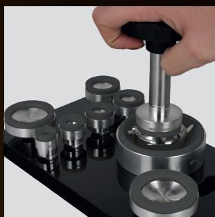
Compatibles avec toutes les potences 5700, ces tasseaux ventouses à haute adhérence permettent d'ouvrir et de fermer facilement les fonds vissés. Leur matière souple se déforme légèrement pour épouser la forme du fond.
